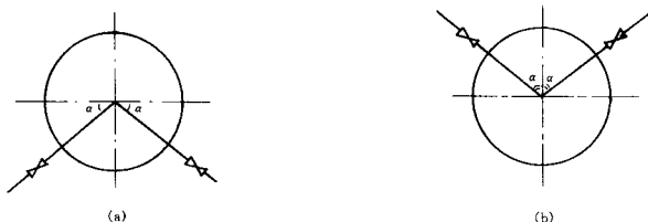
图1 在水平线或倾斜管道上取压口位置示意图 (a) 被测流体为液体时 \alpha \leq 45^\circ ; (b) 被测流体为气体时 \alpha \leq 45^\circ
